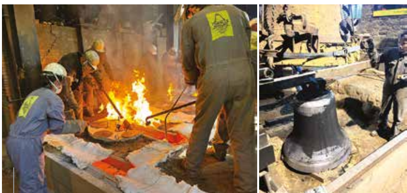
Coulée et décochage de la cloche « CARLO » © Cornille Havard, Villedieu-les-Poêles
